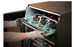
Austauschbare Innenarchitektur für eine schnelle und problemlose Durchführung von Wartungsarbeiten*
